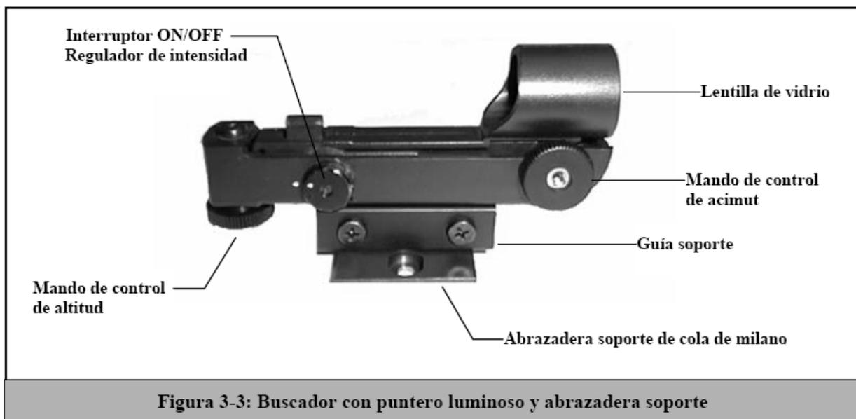
**Figura 3-3: Buscador con puntero luminoso y abrazadera soporte**
