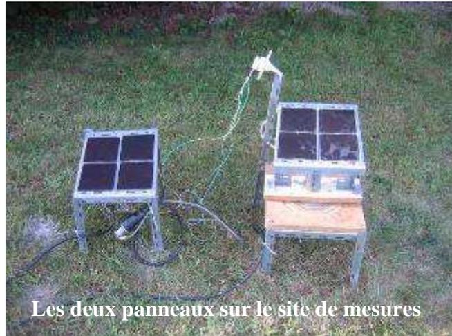
panneau fixe, l'autre rotatif (la rotation est assurée par le moteur d'une minuterie, la puissance électrique consommée est de 26mW). Pour l'acquisition, nous avons utilisé la carte Nidaq6009, nous avons réalisé un petit programme en Labview pour faire l'acquisition.
