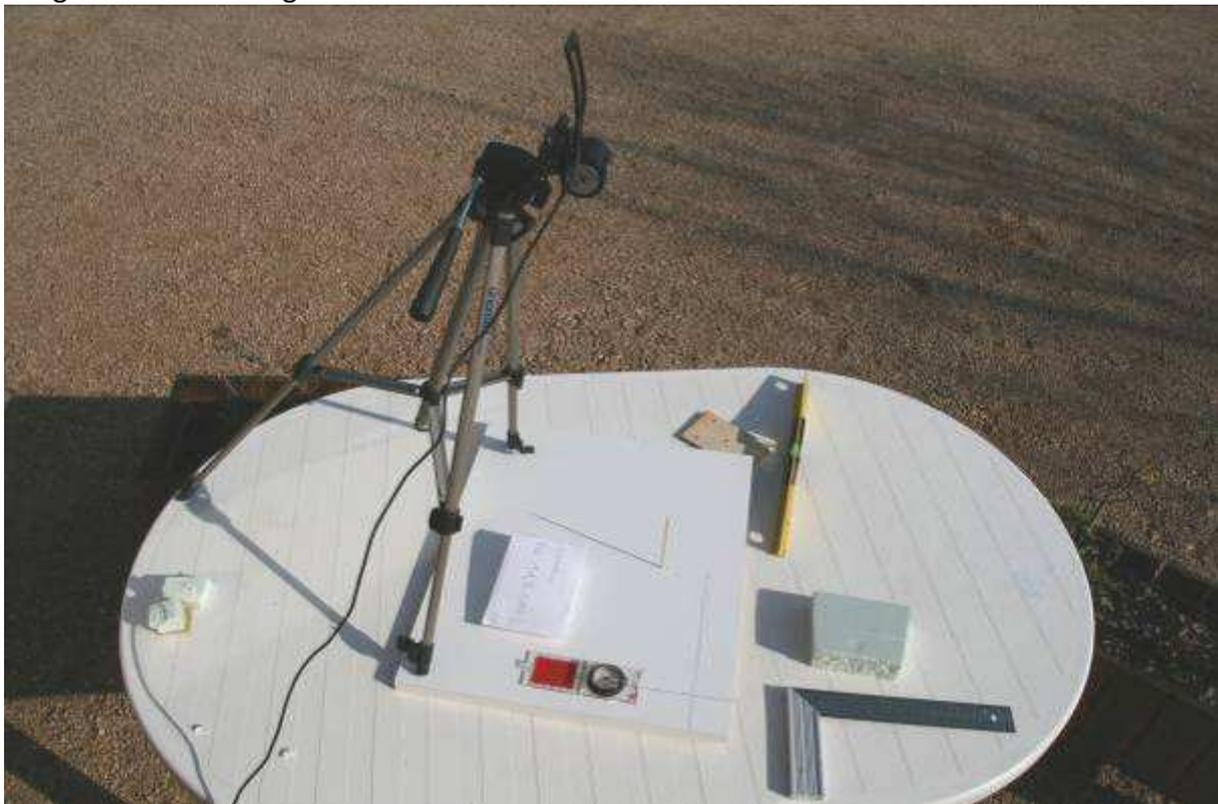
Le gnomon est perpendiculaire au plan de travail, l'un des axes du plan de travail est orienté Nord – Sud à l'aide d'une boussole. Le plan de travail (la base) est positionné horizontalement grâce à un niveau et trois vis.
