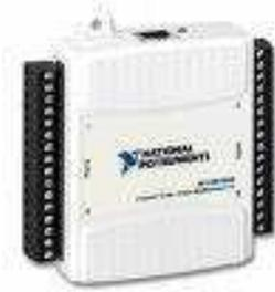
Nous avons réalisé un instrument virtuel (VI) pour pouvoir mesurer la tension aux bornes des cellules photovoltaïques. La carte NI Daq ne pouvant relever que des tensions comprises entre -10V et +10V, nous avons réalisé un diviseur de tension.
